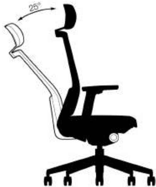
Arretierung der Rückenlehne, Einstellung der Synchronmechanik tilting lock and tension control
