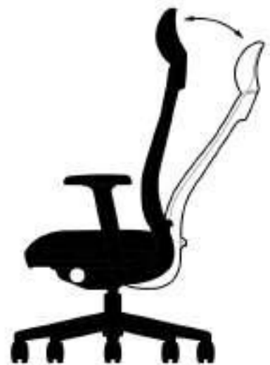
Arretierung der Rückenlehne, Einstellung der Synchronmechanik tilting lock and tension control
